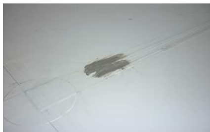
Пример использования «пластилина для ремонта топливных баков»
