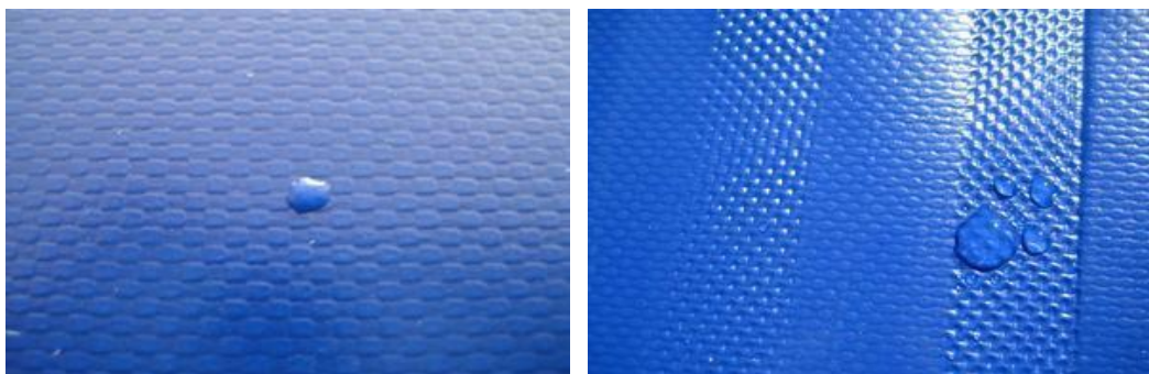
Пример капельного просачивания
